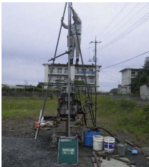
図 2-2 標準貫入試験機の模式図 (半自動式貫入器)
